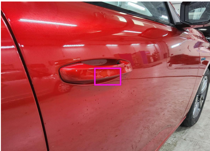
3. Dørhåndtag / Front - Højre Mal / ridse / scuff -
