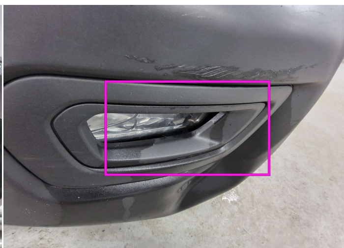
10. Tåge lys / forreste - højre Bodywork / Dent / Deformation -
