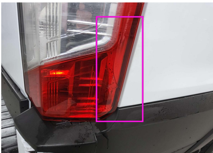
13. Baglys / højre Bodywork / Breakage / Crack -
