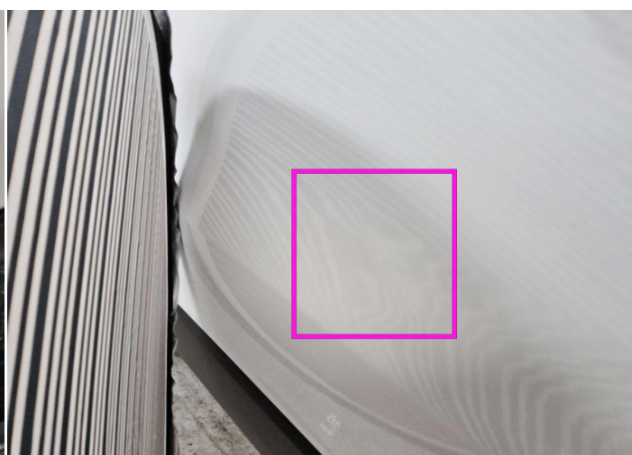
6. Dør / Back - Højre Bodywork / Dent / Dent -
