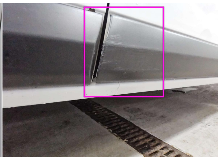
4. Dør side støbning / forreste - højre Mal / ridse / scuff -
