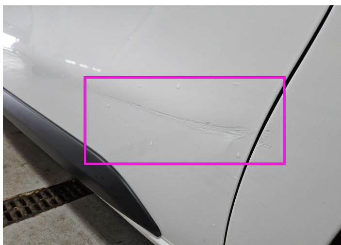
5. Dør / Front - Højre Maling / Defekt håndværk -
