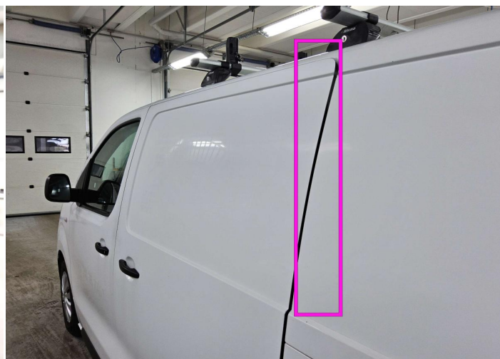
8. Dør / Tilbage til venstre Bodywork / Dent / Deformation -
