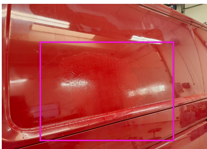
5. FENDER / BACK - HØJRE Maling / Defekt håndværk -
