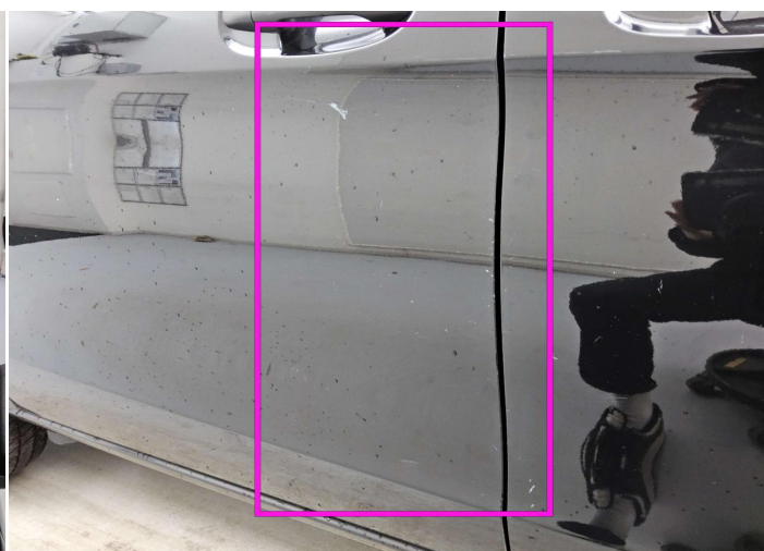
4. Dør / Back - Højre Bodywork / Dent / Dent -
